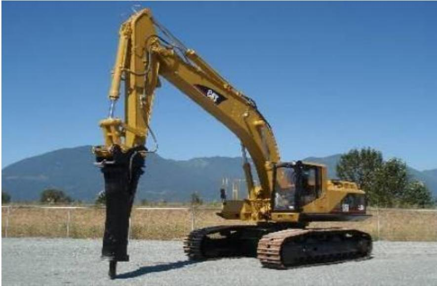
Figura 25. Retroexcavadora con martillo neumático utilizado en el rompimiento del suelo tipo C.
