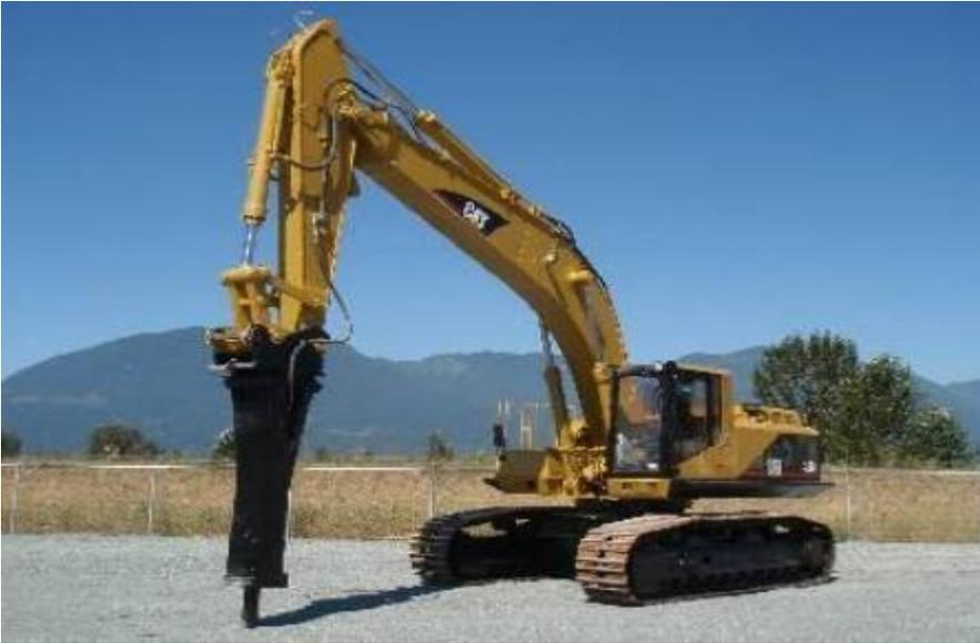
**Figura 58. Retroexcavadora con martillo neumático a utilizar en caso de encontrar suelo tipo C.**
