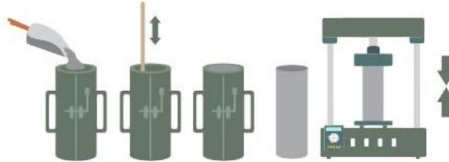
La prueba de compresión implica aplicar fuerza de compresión al concreto hasta que falla, lo que proporciona información sobre su capacidad para soportar cargas verticales y asegura la integridad estructural.
